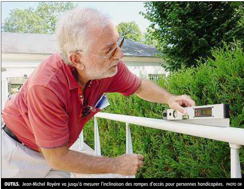
OUTILS. Jean-Michel Royère va jusqu'à mesurer l'inclinaison des rampes d'accès pour personnes handicapées. PHOTO OR
